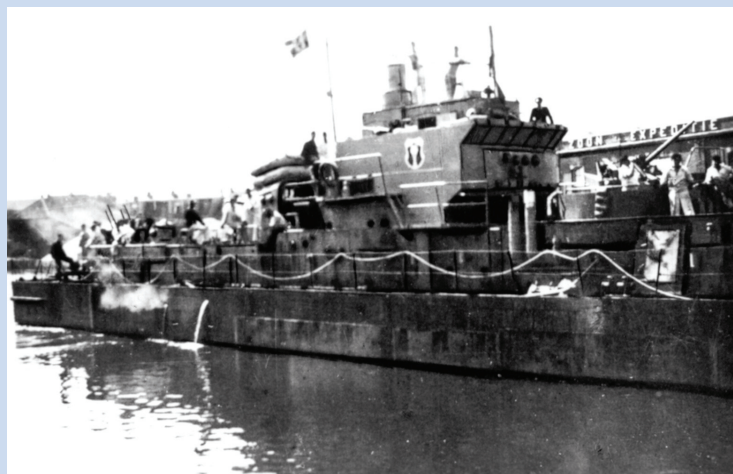
La passerelle de commandement de l'AT 83 avec une tourelle de 88 mm au premier plan à droite.
