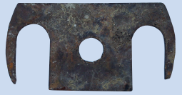
Une pièce d'assemblage double bordée à riveter.
