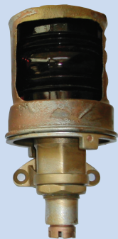
Feu de passerelle bâbord.
