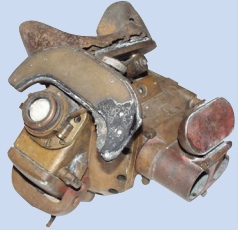
Lunette de visée téléométrique du canon de 88 mm.
